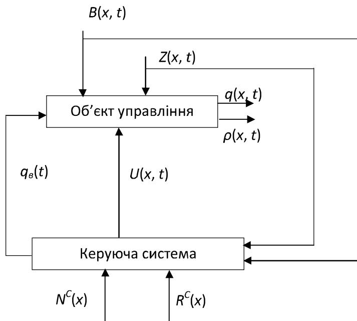
Рис. 1. Структурна схема системи управління матеріальним потоком
